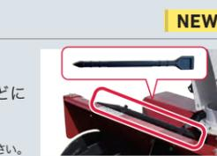
※雪取棒を使用するときは、必ずエンジンを停止させてください。
